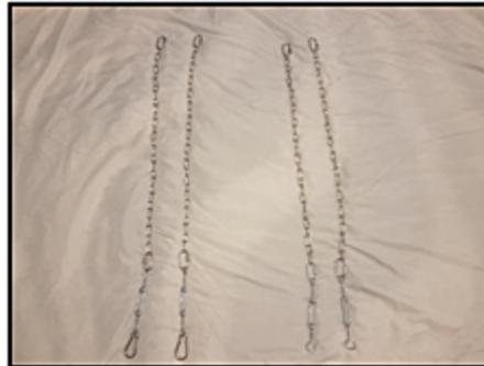
2. Installez les chaînes sur les rails. Installez 2 chaînes par rail, chacune à 20 pouces du centre du rail et alignées avec les bords extérieurs du plénum. Installez les deux chaînes avec clips sur le côté gauche et les deux chaînes avec crochets sur le côté droit. Ajustez la hauteur en tournant les tendeurs (voir IMAGE 7).
