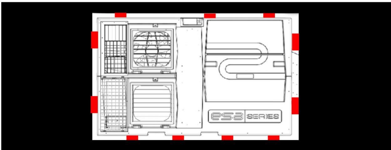
Figure : Placement des cales
