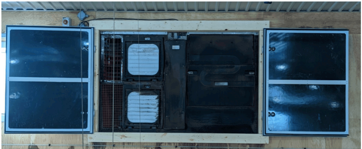
Figure 35 Panneaux isolants installés, en position ouverte
